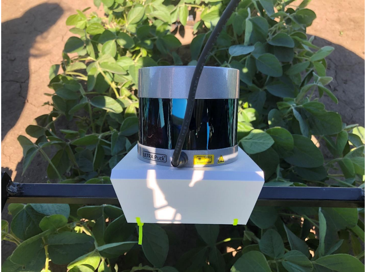
Figure 3.7. LiDAR sensor mounted on Mini Weedbot.
